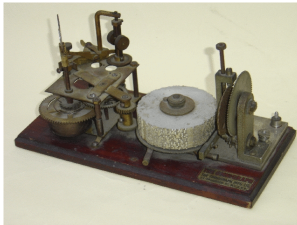
Abbildung H.7: Omnigraph : ein Morse-Übungsgerät um 1901. Ein Uhrwerk (links) drehte mit einstellbarer Geschwindigkeit einen Stapel von Metall-Scheiben, in deren Rand die Morsezeichen eingekerbt waren. Bei der Drehung betätigten sie einen elektrischen Kontakt. Der Kontakt rückte nach jeweils einer Umdrehung selbsttätig von einer Scheibe zur nächsten weiter. [ http://www.faradic.net/gsraven/fons_images/Page_16/12.html ]
