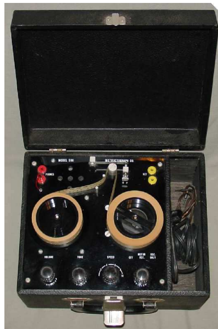
Abbildung H.8: Instructograph: Morse-Übungsgerät um 1930. Die Morsezeichen waren in einen Lochstreifen eingestanzt. Ähnliche Geräte wurden von verschiedenen anderen Firmen bis Anfang der 1960er Jahre angeboten. Die Ähnlichkeit mit den späteren Magnetband-Geräten ist unverkennbar. [ http://www.n4mw.com/cp177.htm ]
