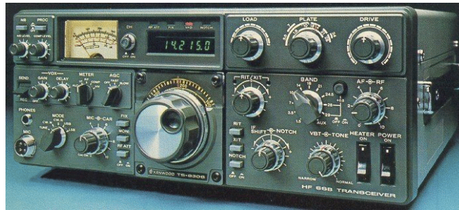
Abbildung H.13: Kurzwellen-Amateurfunkgerät 1981 , vom Typ Kenwood TS-830. Eines der wenigen Hybrid-Geräte, die sowohl integrierte Schaltkreise und eine digitale Frequenz-Anzeige als auch (in der Sende-Endstufe) Röhren besitzen. Von den technischen Daten her können diese älteren Geräte mit den heute hergestellten Funkgeräten in der Regel mithalten und sind diesen nicht ganz selten überlegen. [ http://myweb.tiscali.co.uk/martin.atwsm ]
